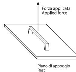
N.B. I dati delle forze di rottura riportati possono diminuire sensibilmente, ( 20-30%) per i maniglioni, se in fase di fissaggio non viene sfruttata tutta la filettatura (Vedere Catalogo Tecnico per la relativa lunghezza). I maniglioni con inserti in ottone presentano una forza di rottura leggermente inferiore. In tabella, oltre alla coppia di rottura in KN viene riportata una forza indicativa in kg.
